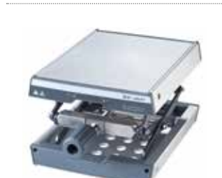
LABLIFT m Os elevadores de laboratório elevam e apóiam pequenos equipamentos de laboratório ou recipientes. É possível elevar um máximo de 7 kg (carga dinâmica máxima) Peso de transporte: até 25 kg (carga estática máxima). A altura de trabalho é entre 70 mm e 300 mm N.º de identificação: 0004022400
