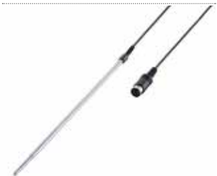
Sensor de temperatura PT 100.70 Profundidade de imersão: 230 mm; diâmetro: 3 mm; Material: Titânio AISI 316 N.º de identificação: 0020000440
